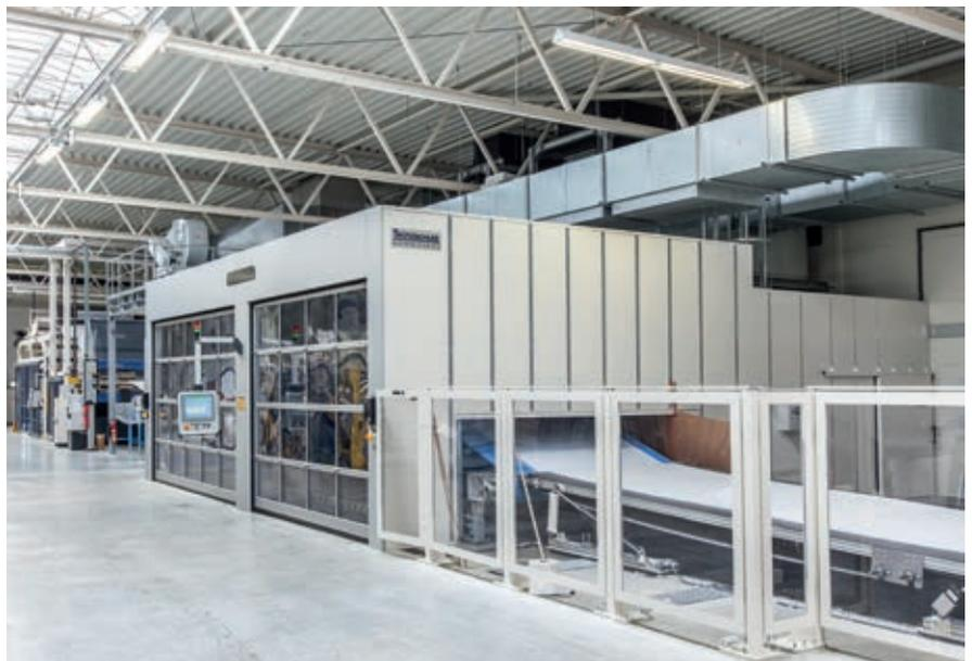
In dieser Anlage werden Vliesstoffe unter hohem Druck mit Wasser verfestigt
